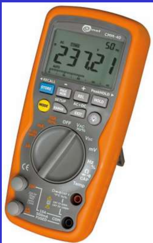
Multimetr z możliwością pomiaru częstotliwości.
